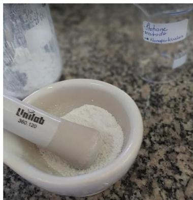
Figura 5 - Obtenção das nanopartículas de ZnO
