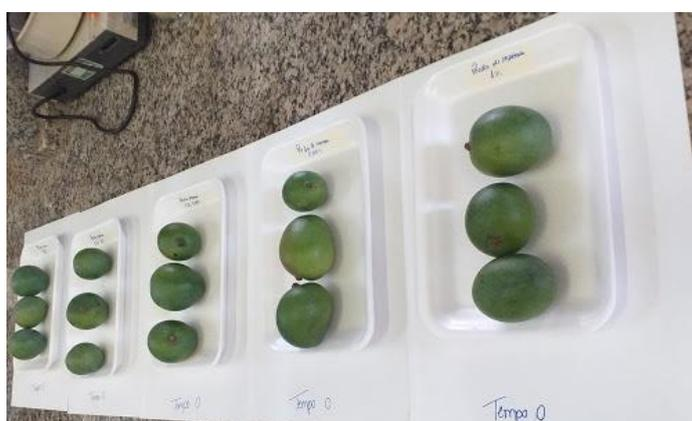
Figura 18 - Disposição das mangas na bancada para pesagem para perda de massa
