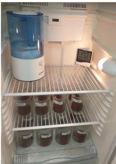
Figura 14 - Análise de biodegradabilidade de filmes de pectina incorporados de nanopartículas de ZnO
